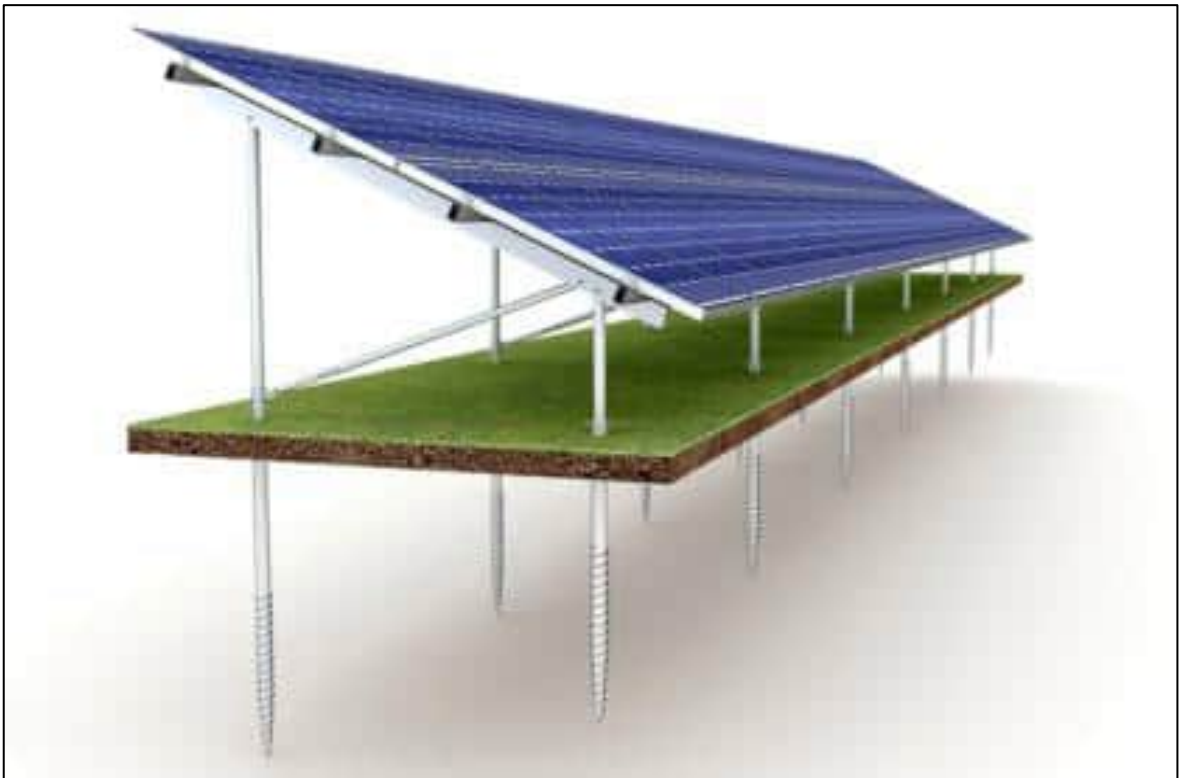
Kuva 7.1 Periaatekuva ruuvipaaluperustuksesta. Kuva: Fortum.
