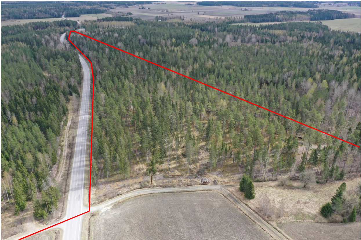
Kuva 13. Suunniteltu sähkönsiirtoreitti kulkee Salontien (vasemmalla) suuntaisena kapenevana käytävänä peltoalueesta kohti itää. Metsäalueen maaperä oli kalliota ja hiekkamoreenia, alavimmilta osiltaan Salontien lähellä savea. Oikealla pellon reunalla oleva heinittynyt matala kumpare koostuu paikalle 1900-luvun puolivälin jälkeen tuodusta maasta. Kuvattu itään.
